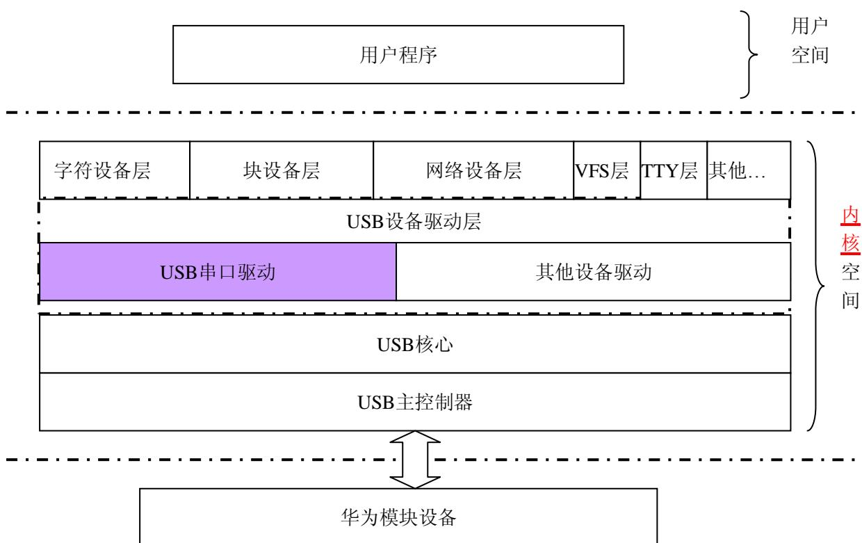
如上图所示，在Linux系统中的USB驱动架构中，跟华为模块设备相关的驱动模块是USB串口驱动模块。其中，
