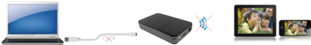
2.按设备电源键开机后连接电脑，设备会处于充电状态，不能做移动硬盘使用，此时终端可以搜索到设备的无线信号，实现 wifi 连接。
