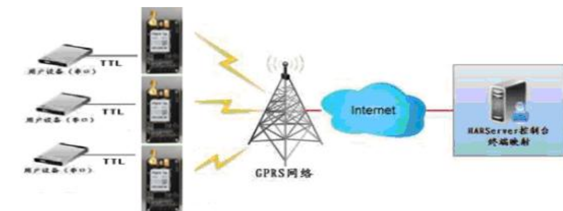
G32 DTU 通过 HARServer 控制台映射实现点对点 (串口对串口)
