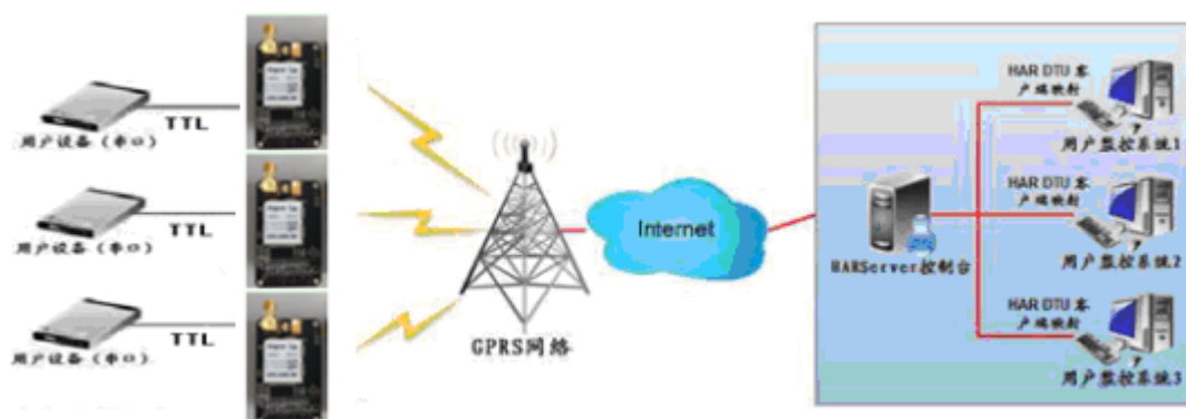
G32 DTU 点到中心通过 HAR DTU 客户端多点监控
