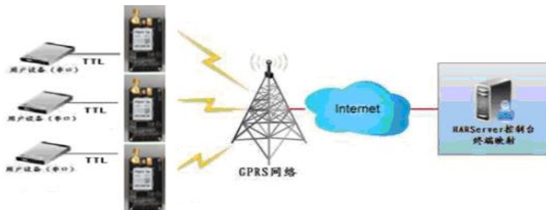
图 4. GM35-EVK DTU 通过 HARServer 控制台映射实现点对点（串口对串口）
