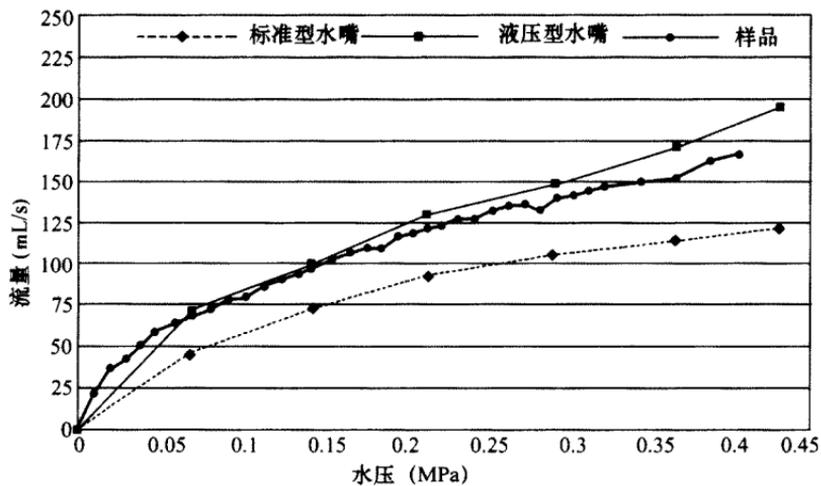
图1 不同水嘴流量与水压关系比较
