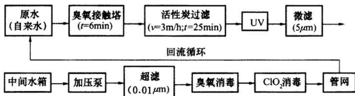
图2 管道直饮水系统工艺流程
